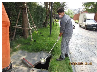
บ่อพักน้ำสุดท้ายของระบบระบายน้ำของโครงการก่อนระบายลงสู่ระบบระบายน้ำ
